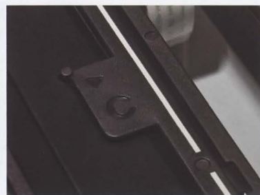
Правильно установить монтажную рамку на планшет помогут специальные выступы и ответные углубления
